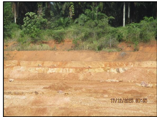
ภาพที่ 2.21 การทำเหมืองแบบขั้นบันได
