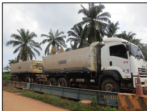
ภาพที่ 2.25 การใช้ผ้าใบปิดคลุมท้ายรถบรรทุกให้มิดชิด
