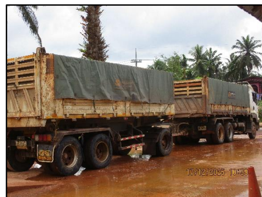
ภาพที่ 2.25 การใช้ผ้าใบปิดคลุมท้ายรถบรรทุกให้มิดชิด
