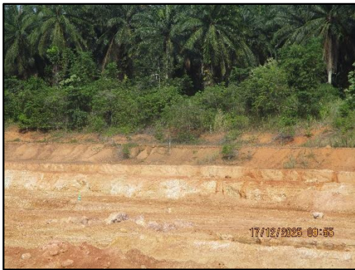
ภาพที่ 2.21 การทำเหมืองแบบขั้นบันได
